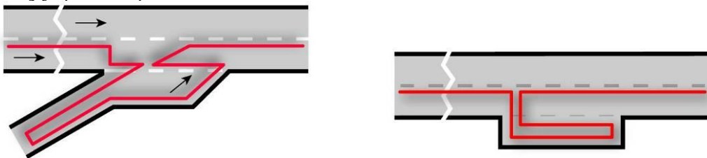
Rys. 4: Okablowanie z uwzględnieniem zatok awaryjnych oraz wyjazdów
